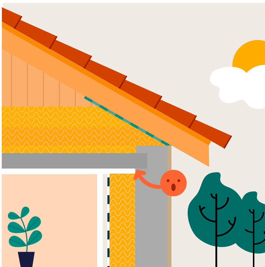
Étape 2 Isolation des murs par l'intérieur
