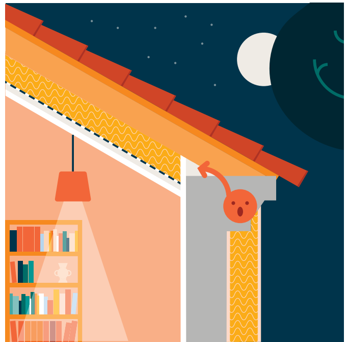
Étape 2 Isolation des murs par l'extérieur
