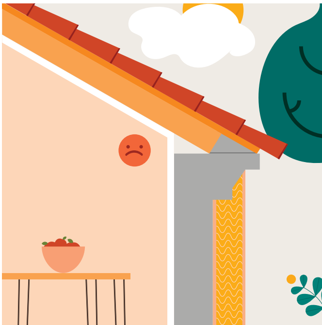
Étape 1 Isolation des murs par l'extérieur
