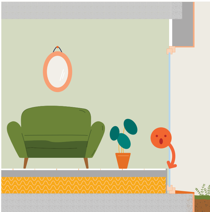
Étape 2 Isolation du plancher bas sous chape
