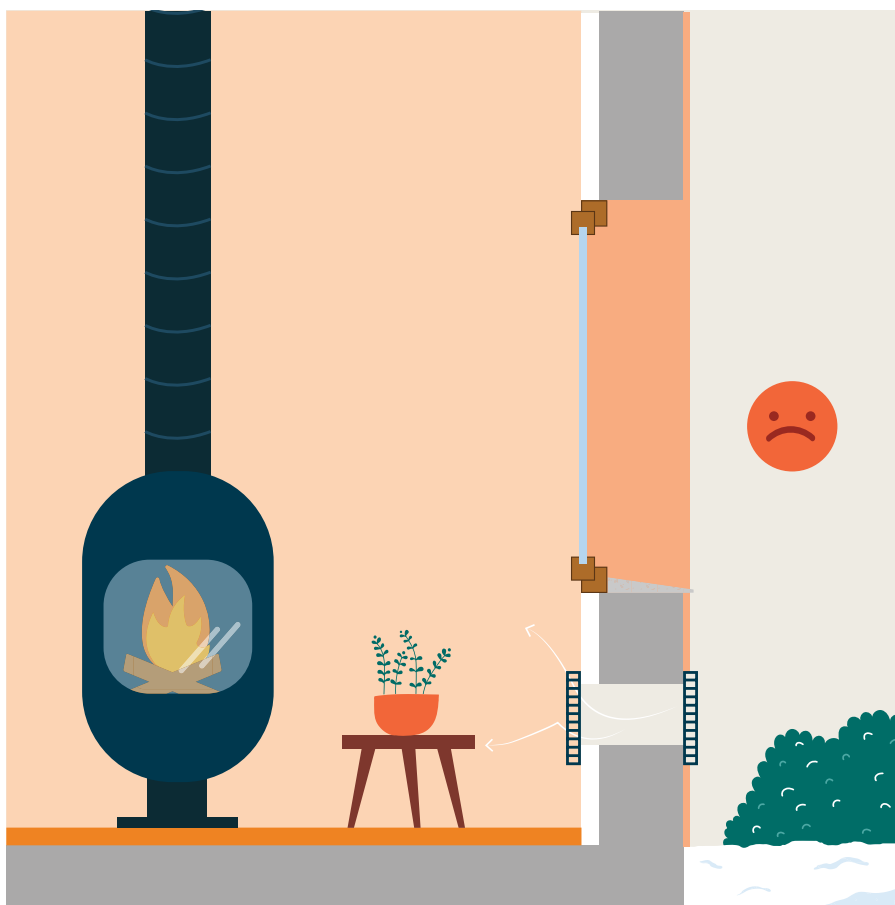
Étape 1 Remplacement des menuiseries extérieures
